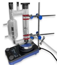
5 - rasm. Gravimetrik usuli yordamida korroziya ingibitorini himoya qobiliyatini baholash uchun Xal-Uek-05 laboratoriya qurilmasi.
